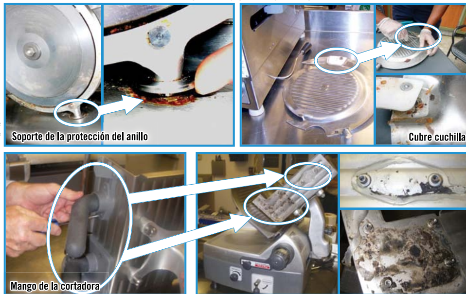
Acumulación de residuos de alimentos en el soporte de la protección del anillo.
